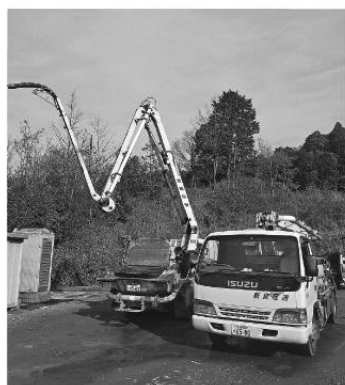
コンクリートポンプ車
